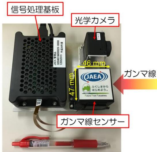
図1 開発した小型軽量コンプトンカメラ
