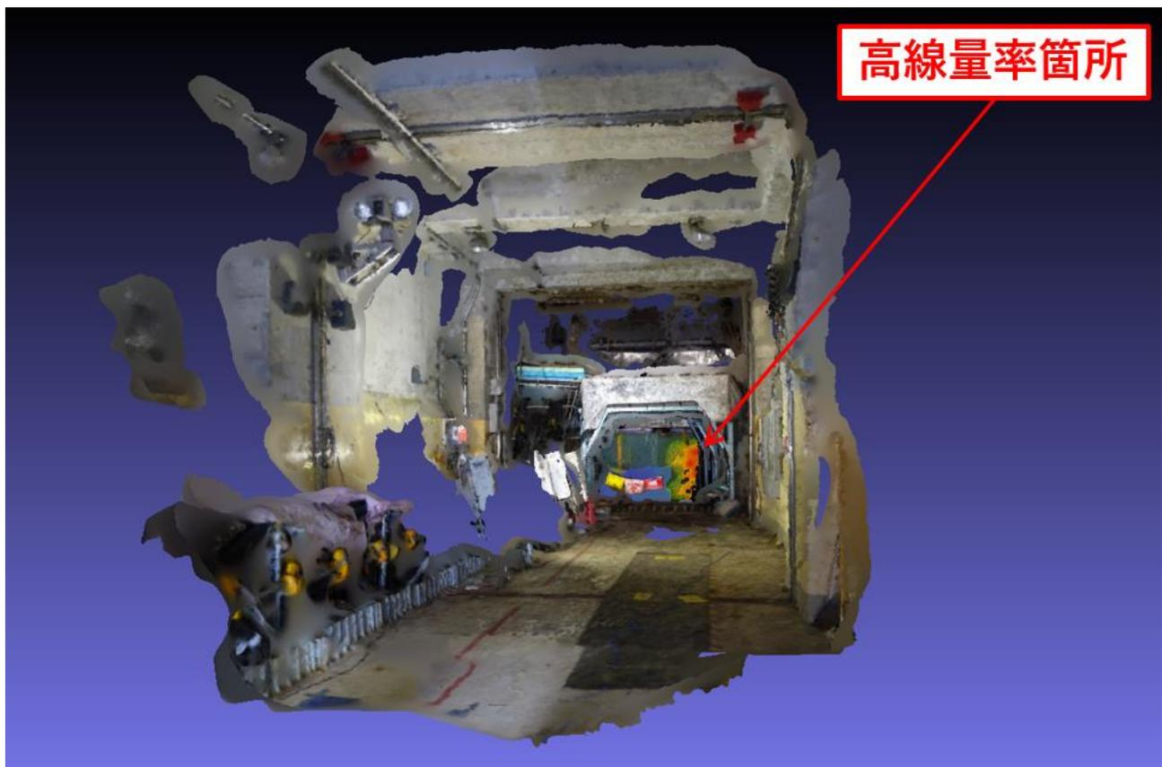
図5 1F1号機原子炉建屋内部の作業現場を3次元モデル化し、ホットスポットのイメージを投影することによって、ホットスポットを可視化した。
