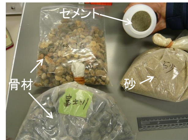
図1 コンクリート原材料の外観
