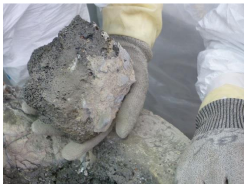
コンクリート境界層
