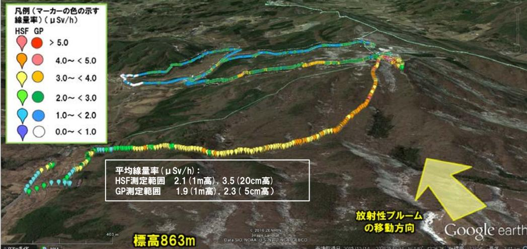
図2 高太石山における地上20 cm (HSF) / 5cm (GP) の線量率(2015年10月8日測定)
