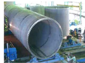
■タワーの組立て
