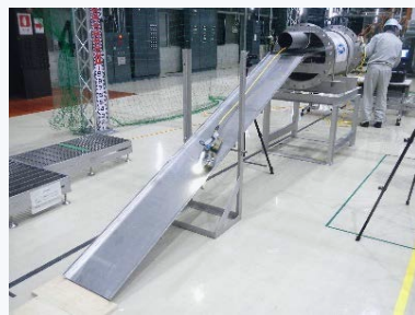
配管走行試験
