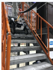
モックアップ階段走行試験
