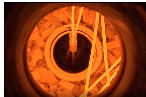
金属系デブリ材が溶融開始 (約900℃)
