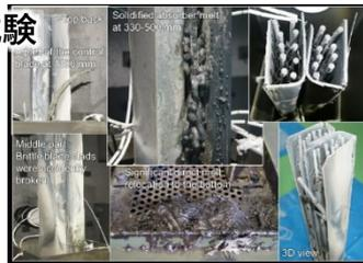
事故シナリオの解明に向けた1F事故を模擬した条件での破損試験や1F建屋内等における放射性物質分布の可視化技術開発などを実施
