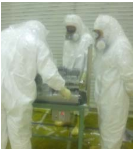
試料の研削作業
