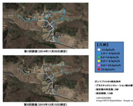
図3 ガンマプロッタHでの測定結果の例（帰還困難区域モデル実証事業の調査地区）
