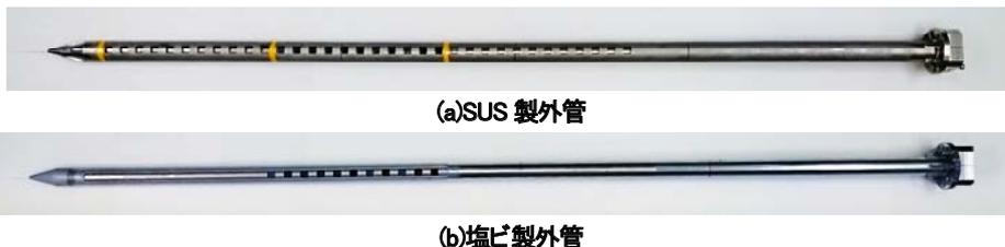
図2 二重管式採取治具の外観
