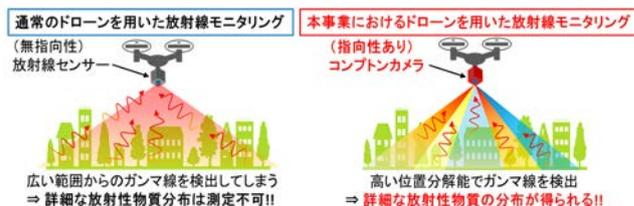
図10 無人飛行体を用いた放射性物質分布測定イメージ図
