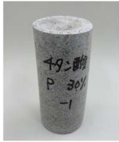
図1 セメント固化試料の外観
