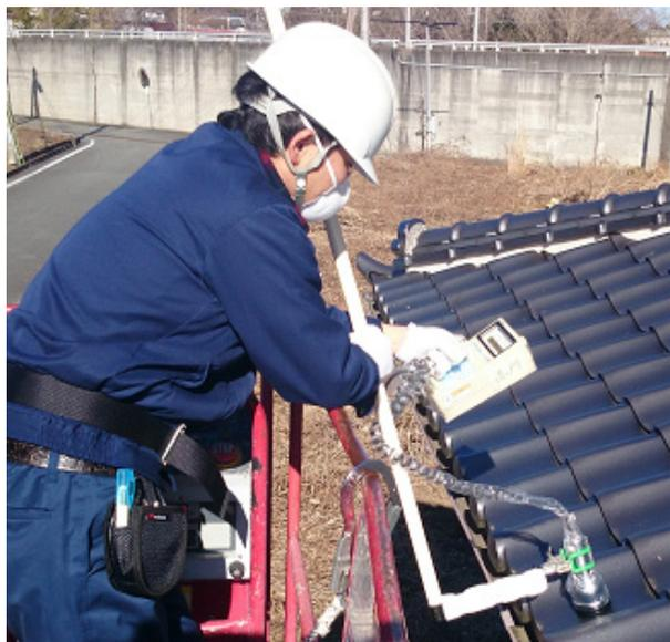
図1 GMサーベイメータによる測定の様子
