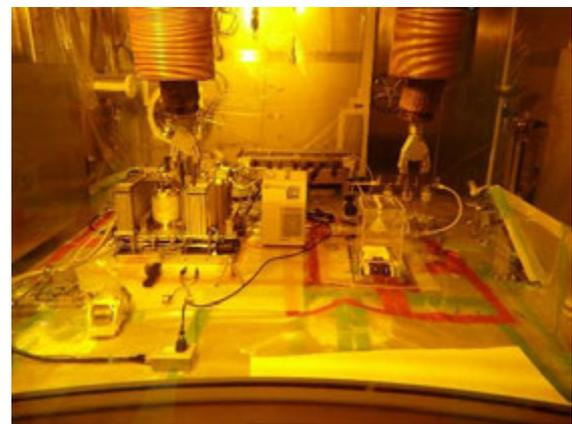
図4 NUCEFホットセル内の試験用電気炉等
