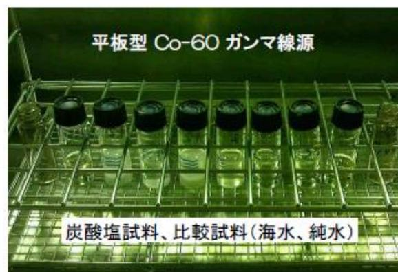
図6 炭酸塩試料のガンマ線照射の様子
