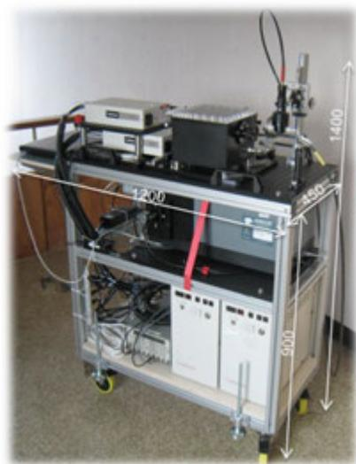
図4 可搬型ラックに組み込んだファイバLIBS装置
