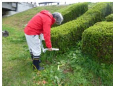
②NaI シンチレーション式サーベイメータによる線量測定
