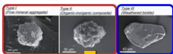
図1 放射性セシウムを多く含む微粒子
