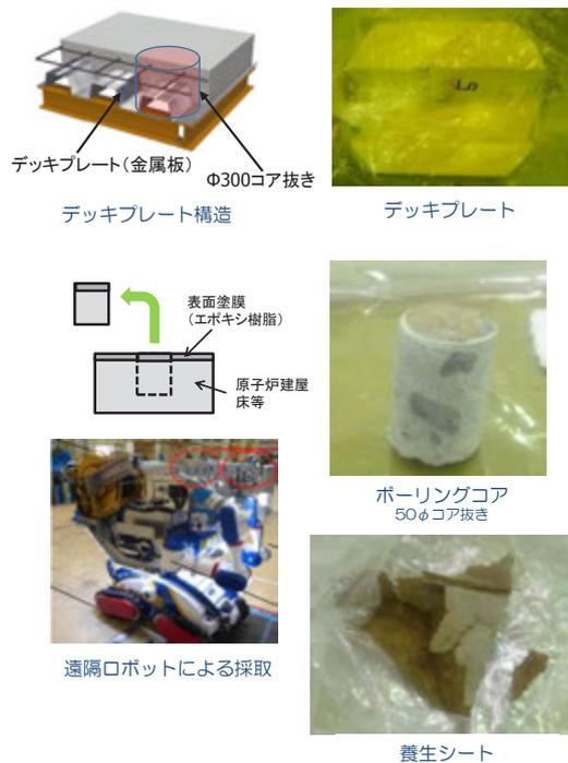
図1 コンクリートコアサンプル採取方法
