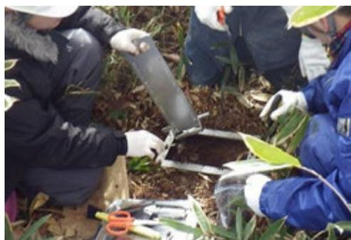
図 2 スクレーパープレートによる土壌試料の採取
