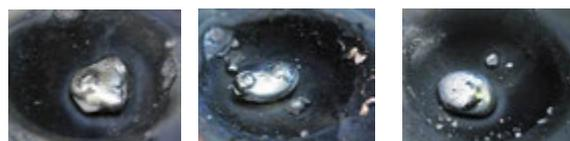
C7-2 模擬MCCI生成物 C8-4 模擬MCCI生成物 N4 模擬炉心溶融固化物
