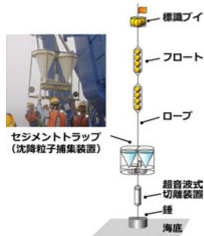
図2 セジメントトラップ係留系の模式図
