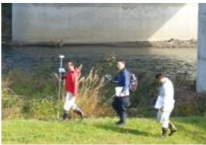
①ガンマプロッタによる線量測定
