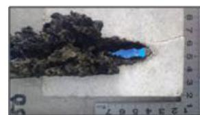
図2 金属を介したセラミックスの切断状況
