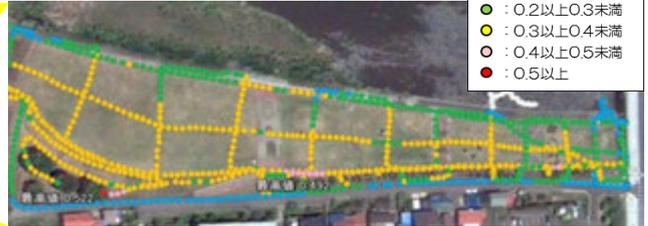
⑤ガンマプロッタによる線量測定結果
