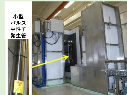
原子力科学研究所/NUCEF/BECKYにあるアクティブ中性子装置(JAWAS-T) 非破壊計測技術開発
