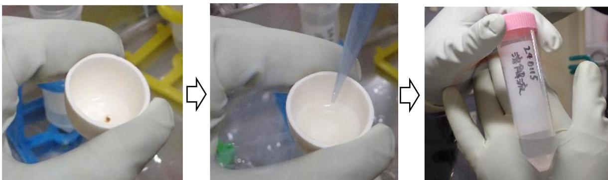
照射済み燃料を模擬燃料デブリとした際の溶解試験の経過
