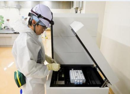
②-2 液体シンチレーションカウンターで測定します。
