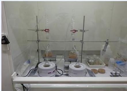
①-3 蒸留により測定を妨害する核種を除去します。
