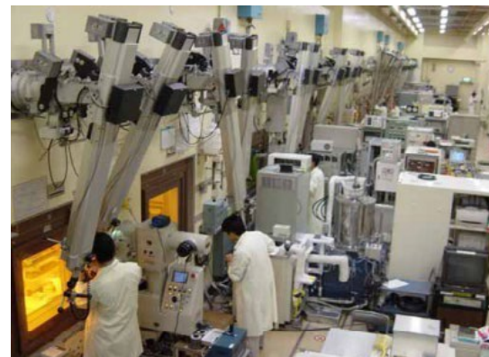
原子力科学研究所/燃料試験施設(RFEF)：軽水 炉使用済み燃料やTMI-2燃料デブリに対するパッシブ ガンマ線測定等への利用を検討中
