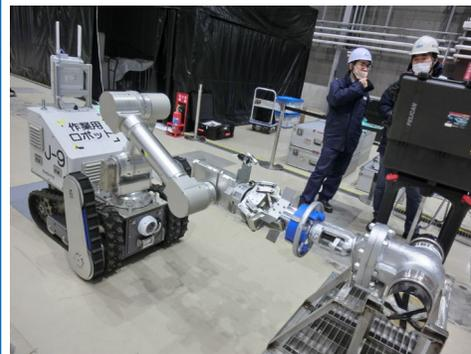
作業用ロボットによるバルブ操作
