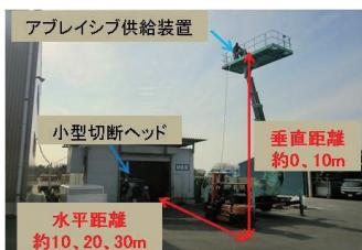
a) アブレイシブ供給の遠距離化影響確認試験
