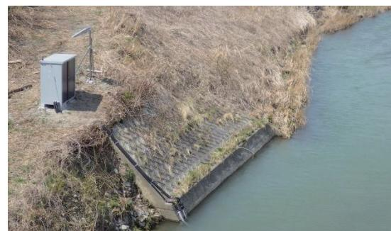
図4 河川自動観測装置(富岡川下流域の例)
