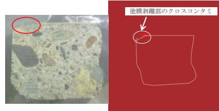
コンクリートコアサンプル 縦断面試料(左)の IP 測定結果(右)
