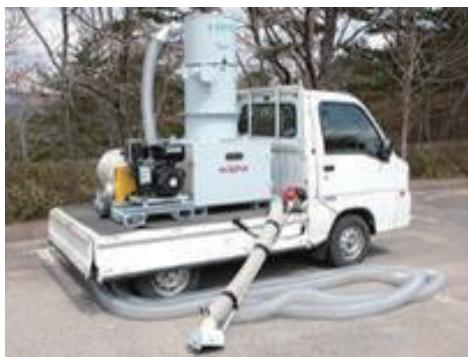
図2 破碎吸引システム
