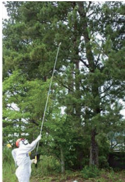
図 2 1F での廃棄物試料の採取
