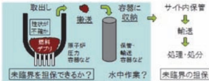
図 3 燃料デブリ取出しから保管、輸送、処理・処分までの臨界管理
