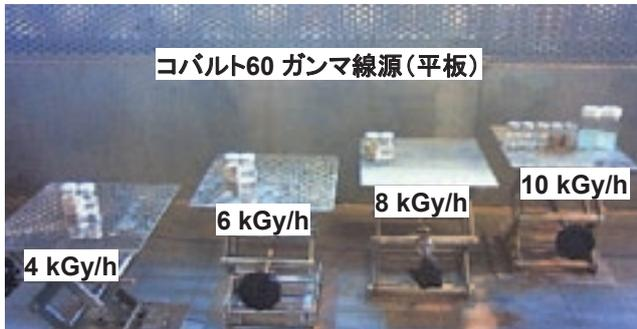
図 1 ガンマ線照射室内の試料設置の様子
