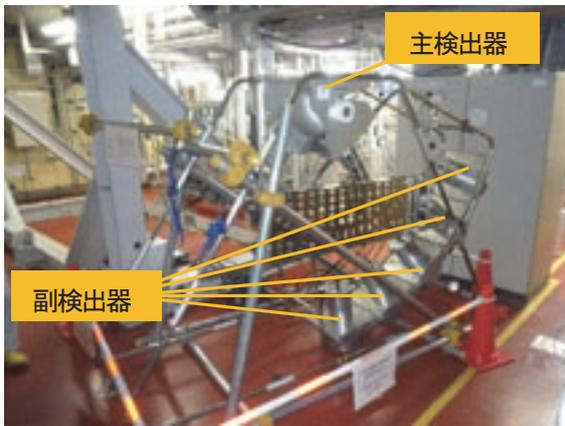
図 1 HTTRに設置したマルチ受光システム
