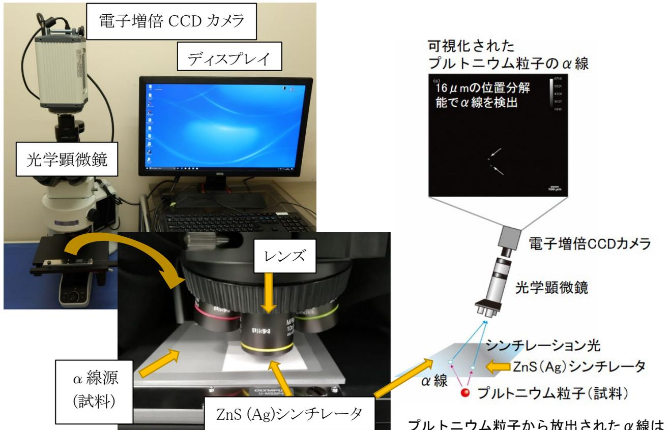
図1 超高位置分解能α線イメージング検出器とプルトニウム粒子のα線の可視化
