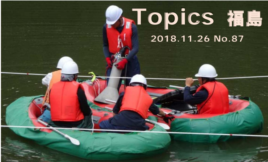
ため池における調査風景(中央部の機器が放射線測定器)
