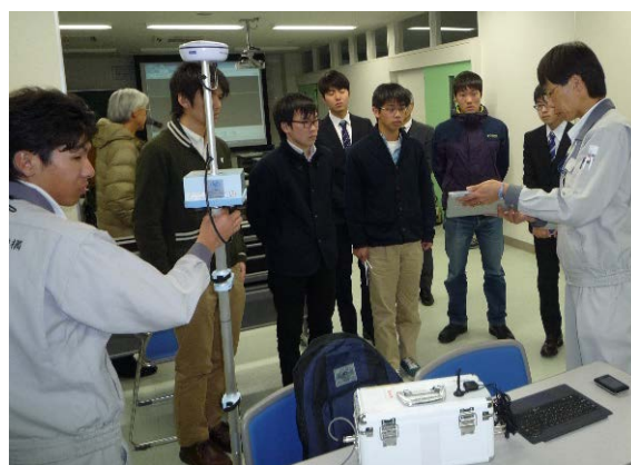
「ガンマプロッタH」は、位置情報と線量率を同時に測定できる
