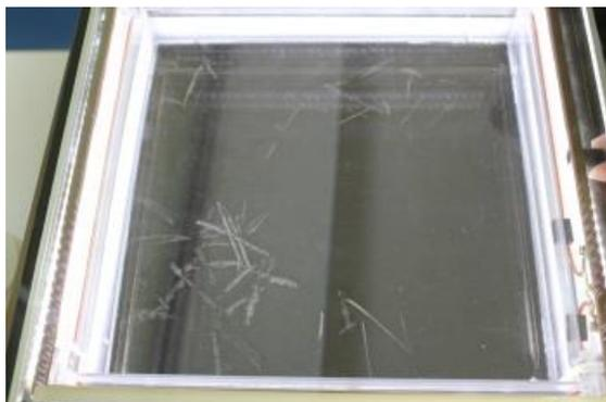
線源を用いずに放射線の飛跡(放射線が通った飛行機雲のような線など=写真左上)を観察することができる。学生らは身の回りには放射線やそれを放出する物質があること、飛跡の違いから異なる放射線があること、さらに、 $\alpha$ 線を出す天然石を線源に用いて、そのまわりを薄い紙で囲むことにより $\alpha$ 線が紙で遮蔽される特徴などを実際に観察した。
