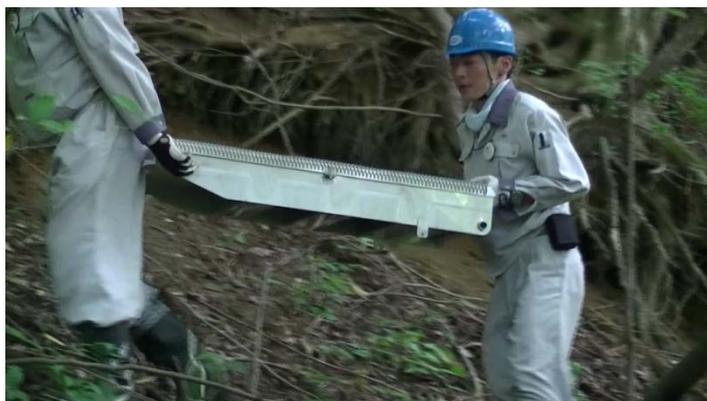
これは、森林の土壤に吸着した放射性セシウムを捕えるにはどうすればよいのかを調べるために、原子力機構が考案、製作した装置だ。
