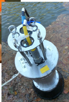
池の中に測定器(写真は右下)を沈めているところ。 測定結果はリアルタイムでパソコン画面に送られる。
