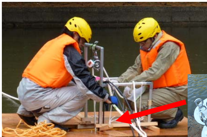
池の中に測定器(写真は右下)を沈めているところ。 測定結果はリアルタイムでパソコン画面に送られる。
