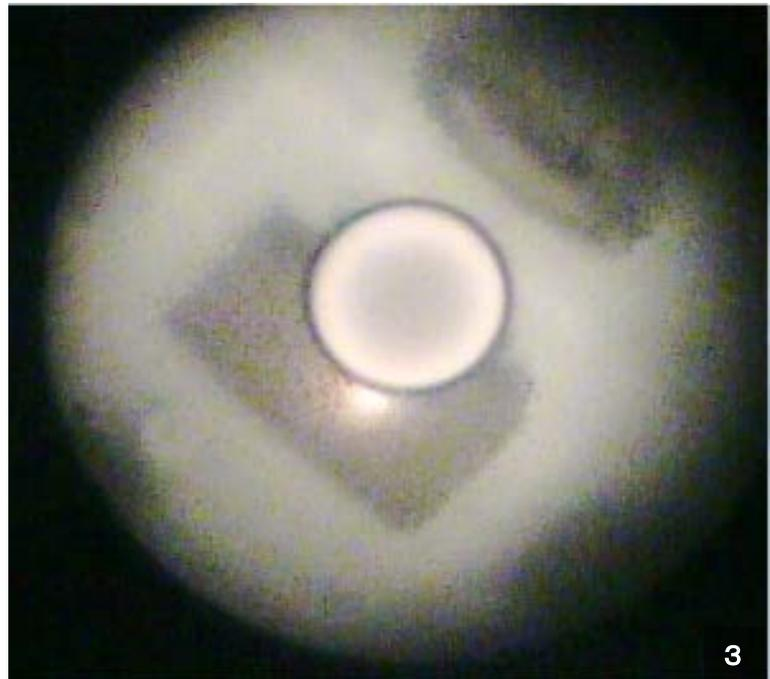
写真2は燃料デブリを模擬したステンレス鋼鉄、写真3はその切断面を水中観察したもの
