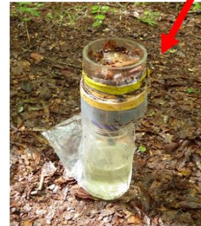
ライシメーターを用いて 土壌浸透水を採取
