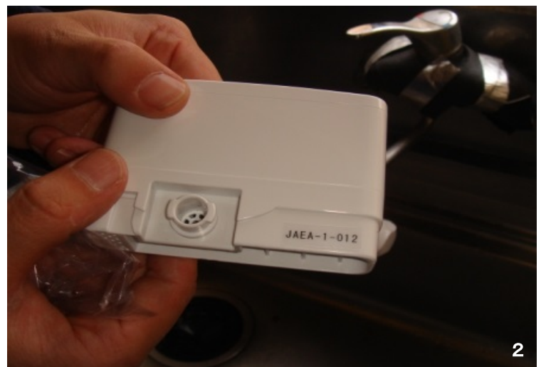
市販の浄水器用ハウジングを利用したカートリッジで取り外して交換する。その中に放射性セシウムを吸着する捕集材が入っている。
