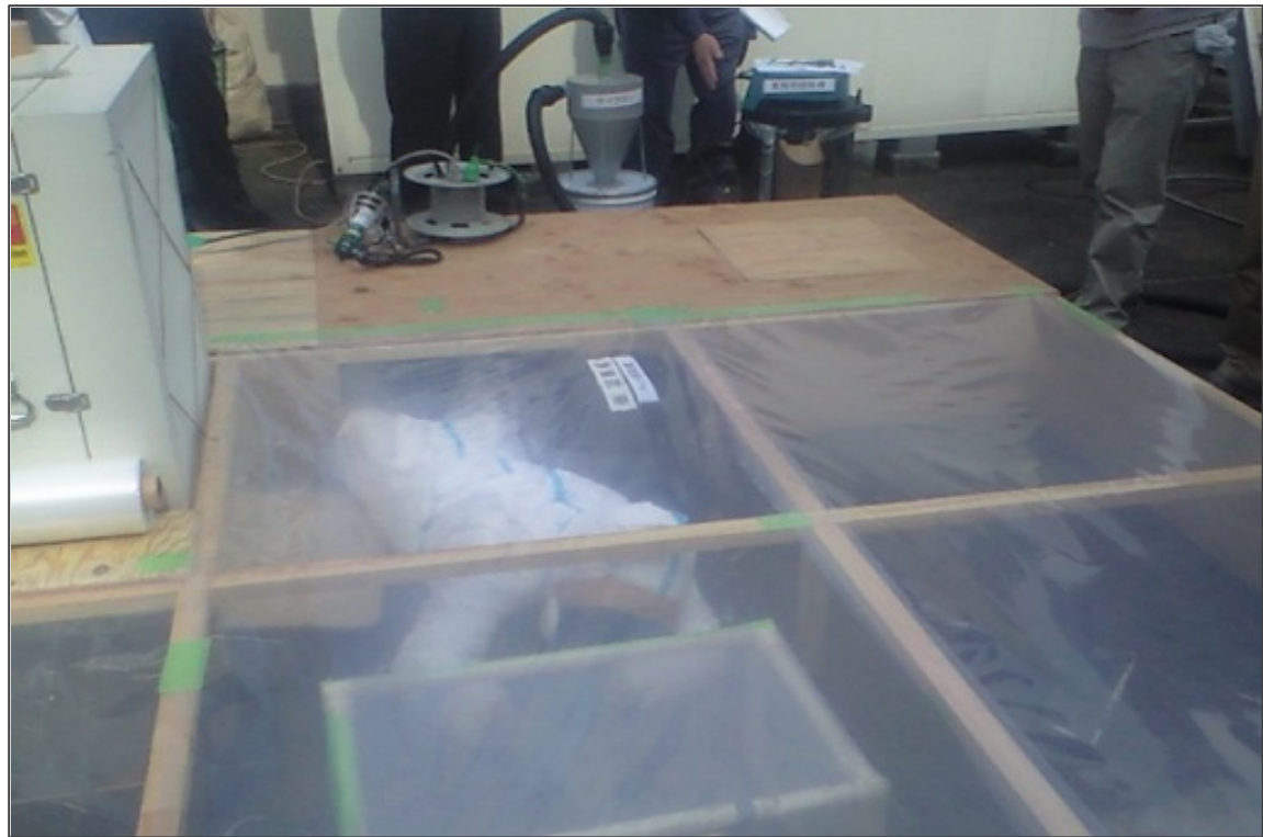
モックアップ試験場(ビルの屋上に床下を模擬)
