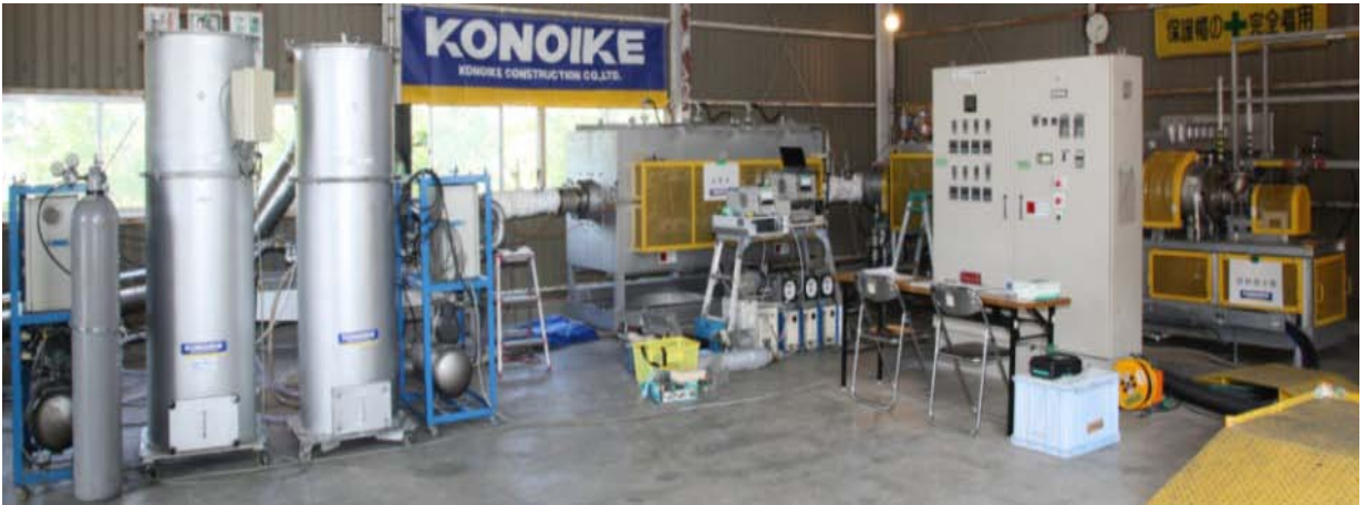
バイオガス化発電により減容化を図る実証試験装置
