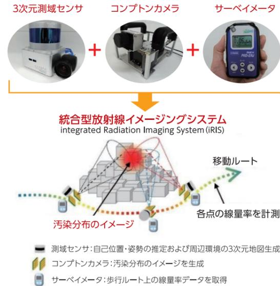
図2 3つの機器の組み合わせによる「iRIS」構築図
