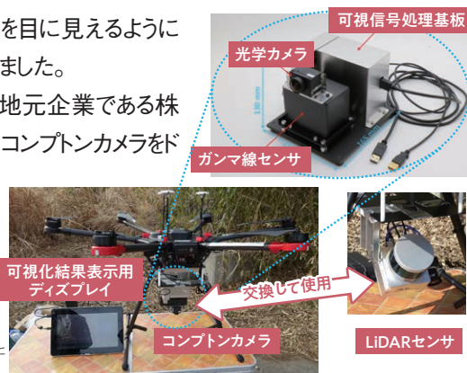
図1. 開発した遠隔放射線イメージングシステム。 搭載した(上図)小型軽量コンプトンカメラと (右図)LiDARセンサ
