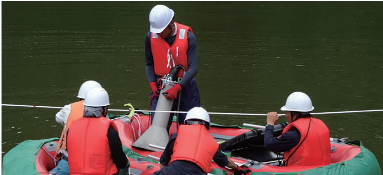
ため池における調査風景(中央部の機器が放射線測定器)
