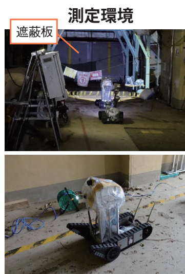
図2. 開発した小型軽量コンプトンカメラ。
