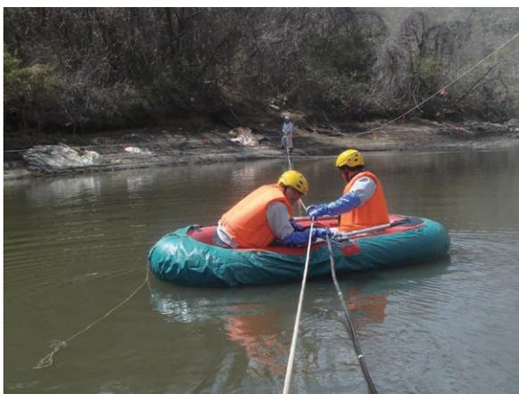
プラスチックシンチレーションファイバ(PSF)を用いたため池の放射線量測定
