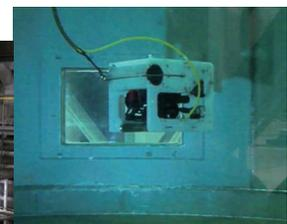
試験用水槽は水中ロボットの実証試験に必要な環境を模擬している
