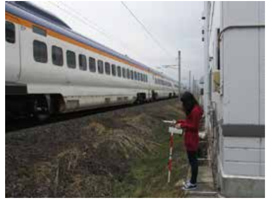
NaIサーベイメータを用いた屋外空間線量率測定の様子
