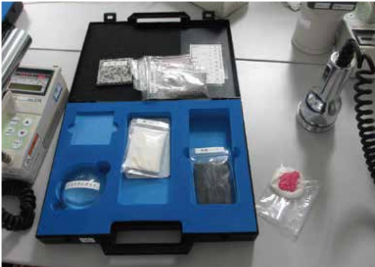
放射線の測定や特徴を知るために用いた試料(こんぶ、御影石、化学肥料、マントル等)や遮蔽材(鉄板)
