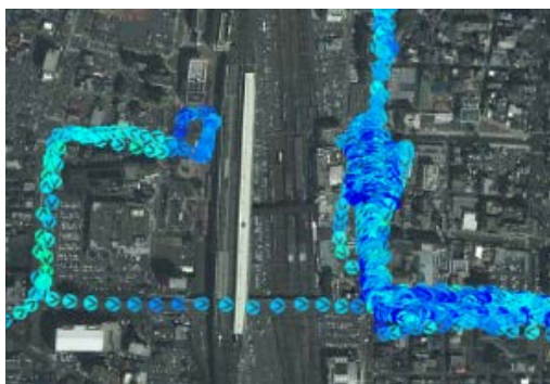
測定中の空間線量率（拡大表示） 走行速度により測定間隔の変化が確認できる。
