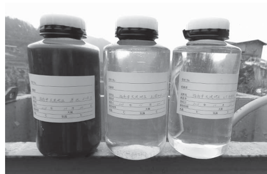
凝集沈殿法による水の状況
