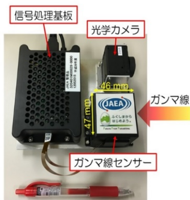
図2. 開発した小型軽量コンプトンカメラ。
