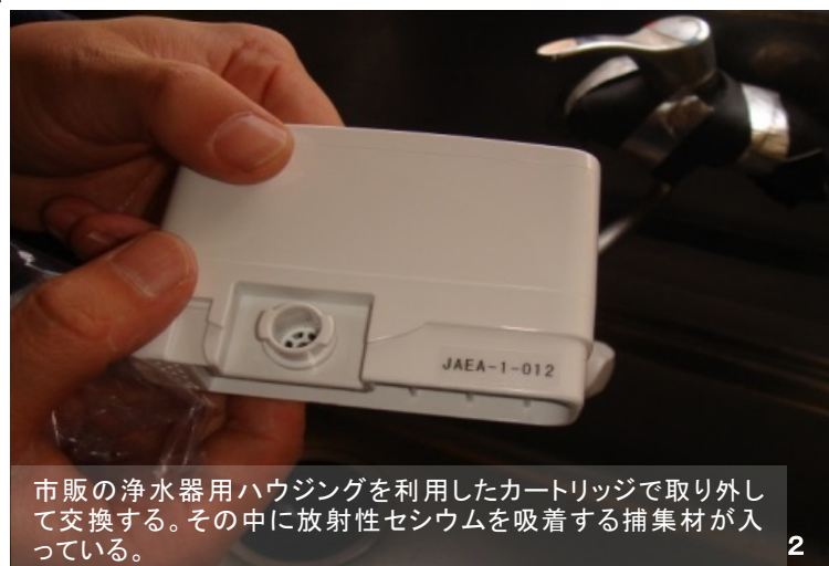
川内村民家の台所の蛇口に取り付けた浄水器
