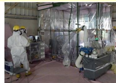
可搬型LIBSによる試料の測定風景
