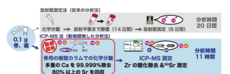
図2 硬組織中 90 Sr の放射能分析法と ICP-MS 法
