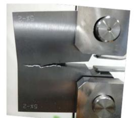
5%冷間加工材の破壊状況
