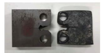
高温加熱試験片(右)での脆性的な破壊(1430°Cx1h 徐冷)
