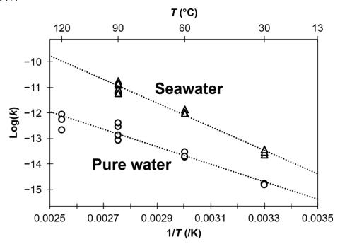
図 1. 放射性微粒子の溶解速度 (k) とその温度 (T) 依存性。横軸は溶液の絶対温度の逆数、縦軸は微粒子の半径の減少速度 (m/s) の対数となっている。丸は各温度 (左から 120  $\mathbb{C}$  、90  $\mathbb{C}$  、60  $\mathbb{C}$  、30  $\mathbb{C}$  )での測定値で、 $\mathbb{C}$  は純水、 $\mathbb{C}$  は純水、 $\mathbb{C}$  は純水、 $\mathbb{C}$
