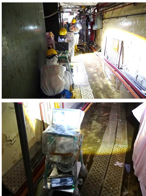
図3 福島第一原発における実証試験の様子(3号機タービン建屋内における汚染分布のコンタ一図)。床面に這わされたホース付近の床面・壁面に局所的な汚染を映し出すことに成功。
