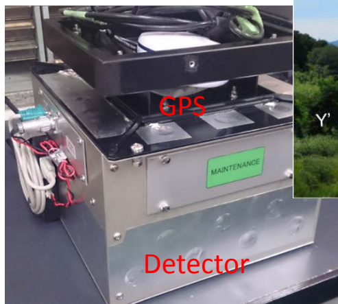
開発したコンプトンカメラ 同時計数法を応用した位置分解能のよい検出器
