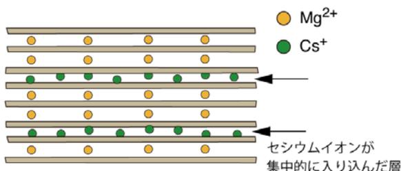
(b) 集団的セシウムイオンの吸着で剥離する粘土層
