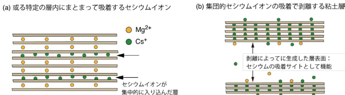
図2 ドミノ倒し的に吸着するセシウムイオンとバーミキュライトの構造変化
