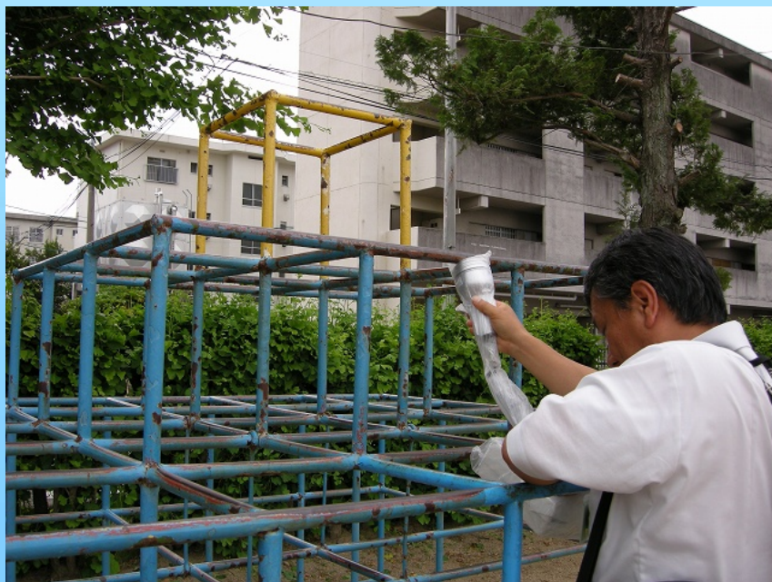
GM管による表面汚染計数率の測定風景
