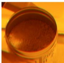
セシウム吸着材のホットセル内での取り扱い
