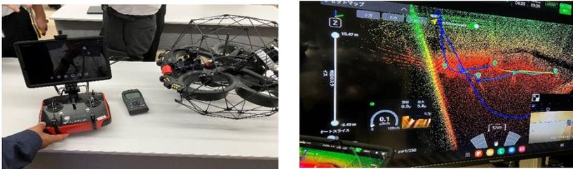
ドローンを遠隔操作し、搭載した検出器によるスキャン結果をリアルタイムで3Dマップ表示する機能試験
