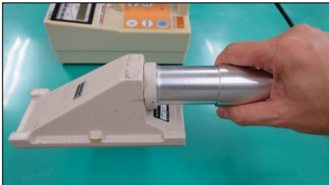
既存のアルファ線検出器 ZnS(Ag)シンチレーションサーベイメータ
