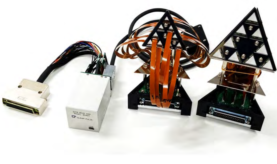
新型放射線検出器FRIE (フリー) フラクタル形状を模擬した測定装置
