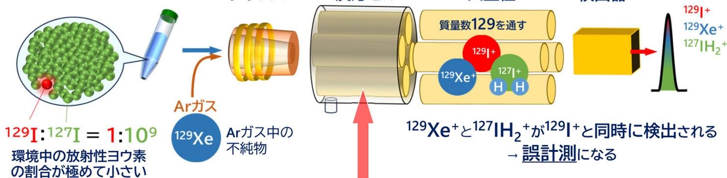
$^{129}\text{Xe}^+$  と  $^{127}\text{IH}_2^+$  の影響を低減するために、セル内でのXeとIに対する酸化反応を利用
