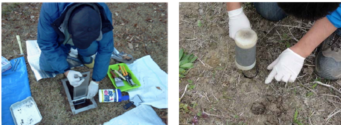
図 14 深度別の土壌試料の採取状況 （左は、スクレーパープレート、右は鉄パイプを用いた採取状況）
