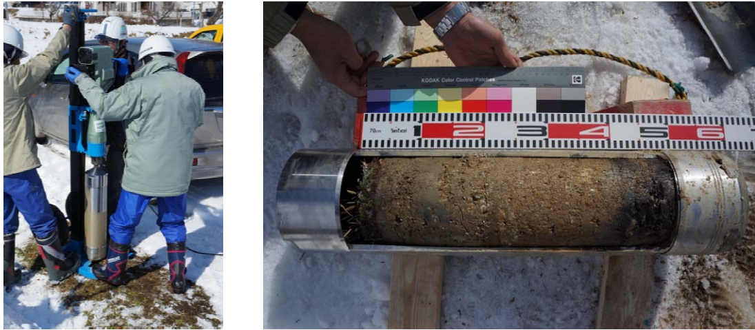
図 20 大口径土壌サンプラーを用いた土壌中深さ方向の放射性物質の分布状況調査の状況
